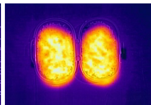
▲冷凍おにぎりを加熱した際の温度分布を可視化したもの (左：三角形 右：おにぎりがう米わん)
